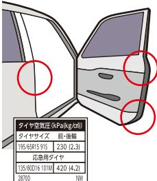
●タイヤの空気圧が規定値であることを確認し、空気圧が低い場合は、規定値まで補充して下さい。規定値は、運転席ドア付近に貼られているステッカーで確認してください。
