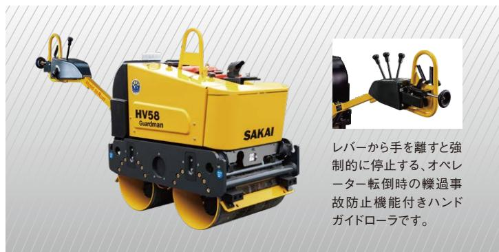
レバーから手を離すと強制的に停止する、オペレーター転倒時の転過事故防止機能付きハンドガイドローラです。
