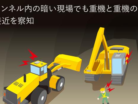
作業員だけでなく重機と重機の接近も検知可能です。
