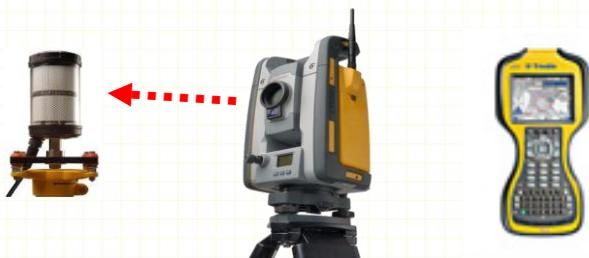
トータルステーションは任意の場所に設置し、データコレクタを使って「後方交会法」で機械位置を設定します（上記写真はトリブル）
