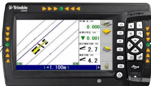
「前後方向」「左右方向」「高さ」それぞれの設計面に対する差分を3つのライトバーで表示します。
