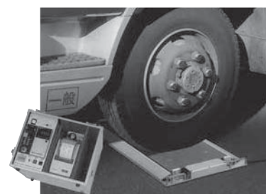
2軸車の測定例(平坦で堅牢な路面で測定した場合)
