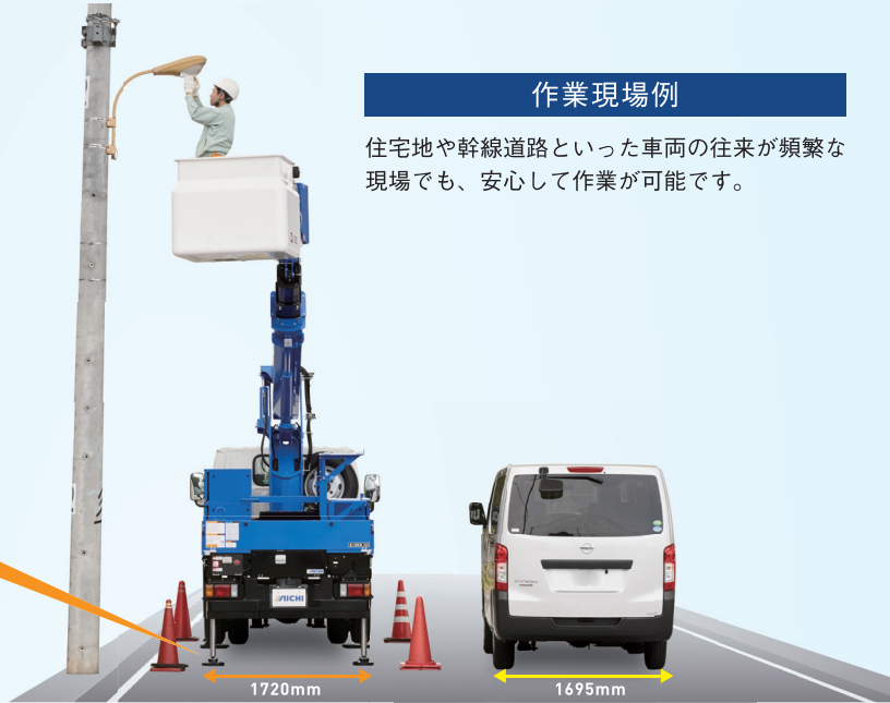
直下型ジャッキの採用により、設置占有幅を最小化しました。
