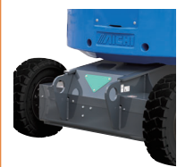
吊りフック掛け (後)
