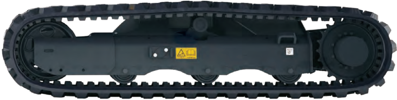
強固な足回り 独自の厳しい耐久基準をクリアし、履帯外れや磨耗を防ぎます。
