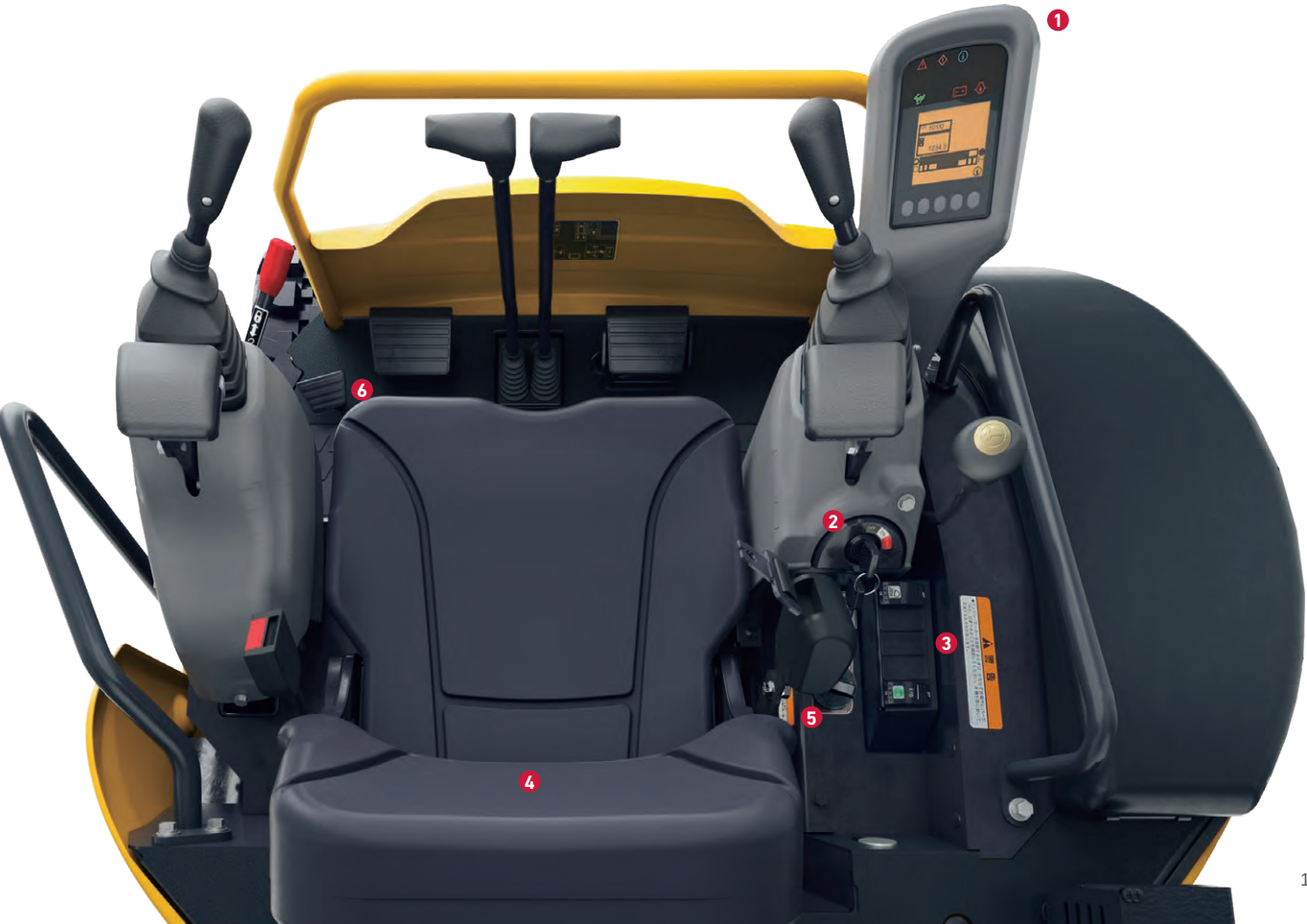
5 ダイアル式アクセル 作業に応じて手元で簡単にエンジン 回転数の調整が可能です。 ※オートデセル仕様の場合
