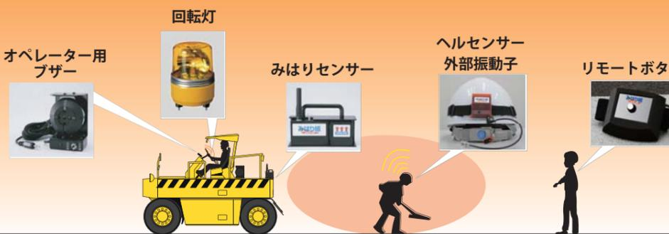
みはり組は重機後部に付ける発信部「みはりセンサー」と作業員のヘルメットに取り付ける受信部「ヘルセンサー」、運転席にブザー音を鳴らす「オペレーター用ブザー」、「みはりセンサー用小型充電器」、「ヘルセンサー用充電器」の 5 点から構成されています。
