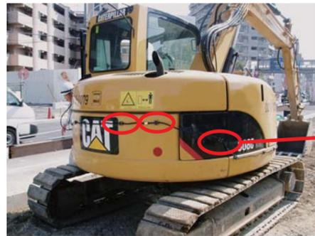
バックホウの作業半径内 (2m) に作業員が侵入すると、作業員と重機オペレーターの双方に「音」と「振動」で危険を知らせます。重機にフレキシブルセンサー (発信器)、作業員にヘルセンサー (受信器) を装着します。
