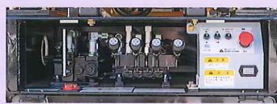
ジャッキ操作装置と下部操作装置を一体化
