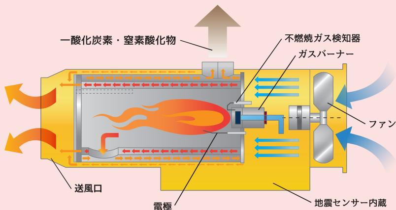
燃焼に必要な燃料とエアーが専用回路から供給され、燃焼が始まると燃焼室が高温になります。高温状態になった燃焼室と本体ボディの間を、大型ファンで引き込まれた空気が通過することによって、クリーンな温風を排出する仕組みとなっています。
