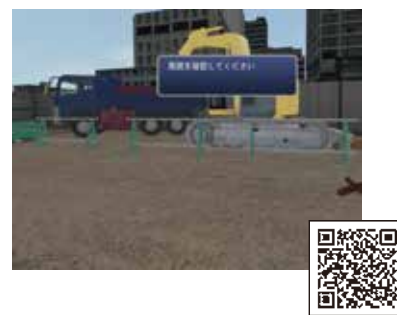
③ 掘削機旋回時衝突災害
