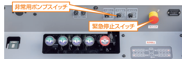
車両後端操作部
